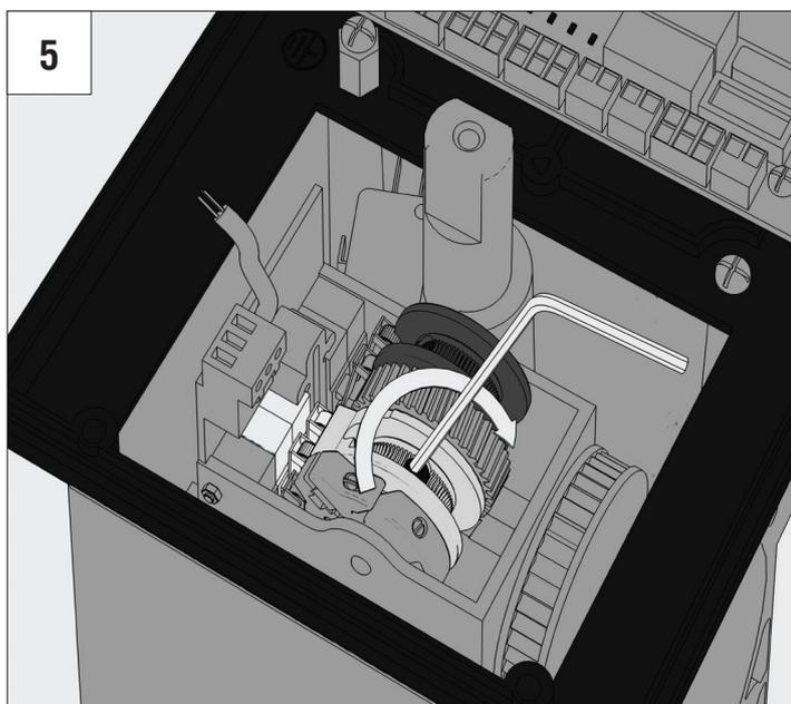
УСТАНОВКА КОНЦЕВЫХ ВЫКЛЮЧАТЕЛЕЙ НА ОТКРЫТИЕ / INSTALLATION OF END SWITCHES FOR OPENING
