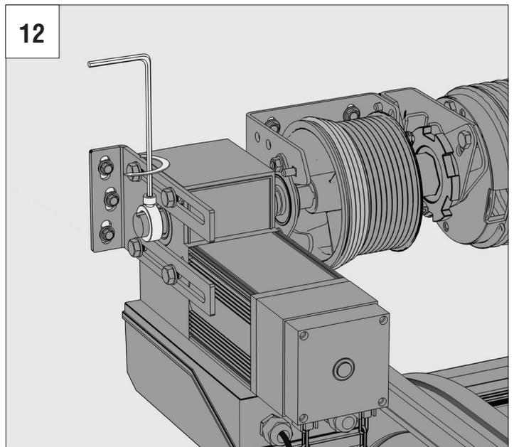
НАСТРОЙКА КРАЙНИХ ПОЛОЖЕНИЙ / ADJUSTMENT OF EXTREME POSITIONS
