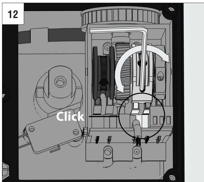
РАБОТА РАСЦЕПИТЕЛЯ / RELEASE MECHANISM OPERATION
